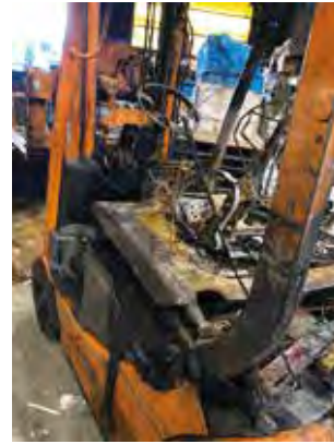
焼損したフォークリフト
